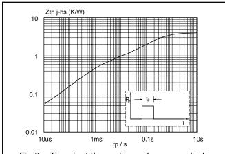
Fig.6. Transient thermal impedance per diode;  $Z_{th j ext{-}hs} = f(t_p)$ .
